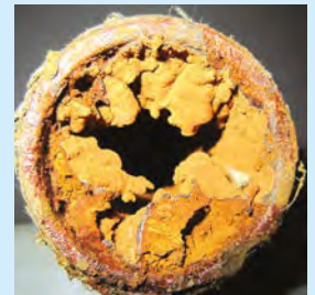
Ruoste- ja kalkkikerrostumaa käyttövesiputkessa.
